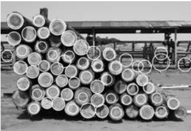
図-7. Hough 変換 (円) による抽出結果 ※抽出部分は円で囲む。
